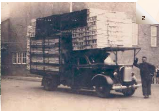
2 De Ford uit 1938 die op gas loopt. Zie de gasketel in het midden van de laadruimte. De wagen is volgeladen met kroppen sla.
